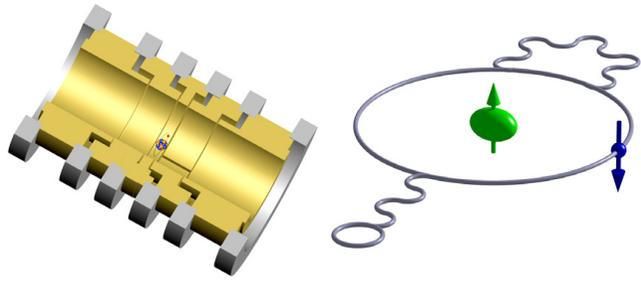
Links: In einer zylindrischen Penningfalle gespeichertes hochgeladenes Ion mit nur einem Elektron. Rechts: Schematische Darstellung der quantenelektrodynamischen Effekte eines Elektrons (blau), das eng an einen schweren Kern (grün) gebunden und dem extrem starken Feld des Kerns ausgesetzt ist.
