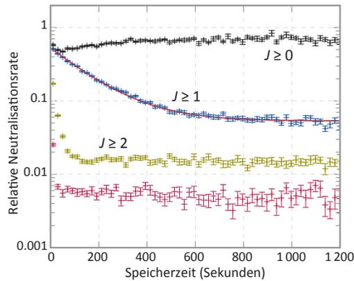
*Kühlung der Rotation von OH<sup>-</sup>-Ionen im CSR. Ein Laser neutralisiert die OH<sup>-</sup>-Ionen. Die Quantenzustände J der Rotation sind verschieden stark angeregt. Auch der tiefste angeregte Zustand (J=1) verschwindet nach ca. 10 Minuten. Danach sind bis auf wenige % alle OH<sup>-</sup>-Ionen im Grundzustand J=0.*
