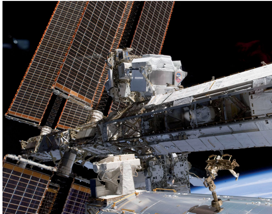
Abb. 1 Das Alpha Magnetic Spectrometer AMS-02 an der Internationalen Raumstation ISS, etwas oberhalb der Bildmitte (Foto: NASA).
