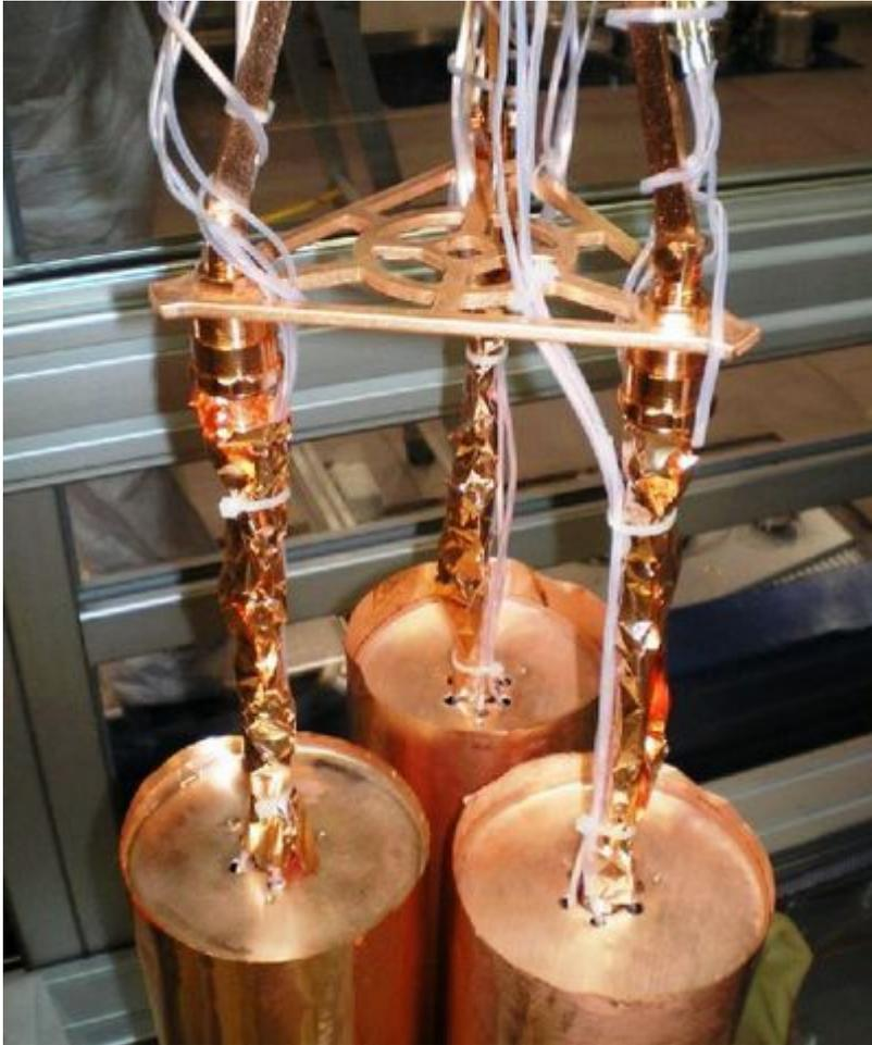
Abb.: Zur Abschirmung sind die Germaniumdetektoren mit einer Folie aus hochreinem Kupfer umhüllt. (Bild: MPIK)
