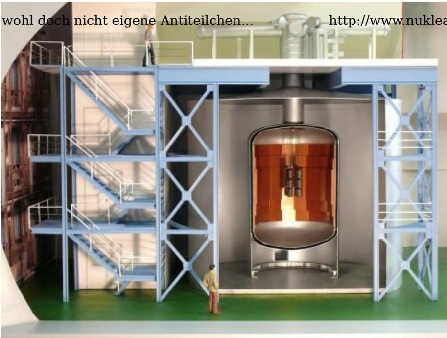
*Das Modell des Gerda-Experiments zeigt den schalenartigen Aufbau, bei dem zur Minimierung störender Signale aus der Umgebung von aussen nach innen immer reinere Materialien eingesetzt sind. Die Germanium-Dioden im Inneren des mit 64'000 Liter flüssigem Argon (-186 °C) gefüllten Kryostaten sind vergrössert dargestellt.*
