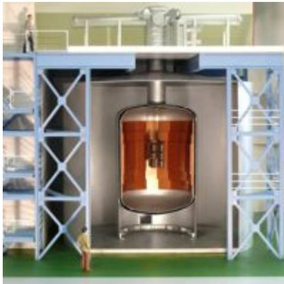
Das Modell des GERDA-Experiments zeigt den schalenartigen Aufbau, bei dem zur Unterdrückung störender Signale aus der Umgebung von außen nach innen immer reinere Materialien eingesetzt sind. Die Germaniumdioden im Inneren des mit 64.000 Liter flüssigem Argon mit einer Temperatur von minus 186 Grad Celsius gefüllten Kryostaten sind vergrößert dargestellt. **Bild:** MPIK
