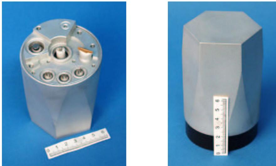
**Abbildung 4.11:** Gekapselter, 6-fach segmentierter MINIBALL-Detektor.
