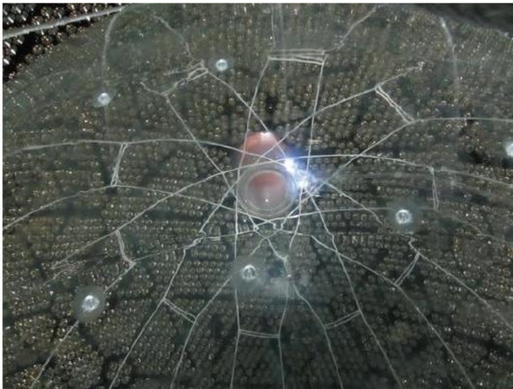
photo of SNO+ AV Hold Down Net installed
