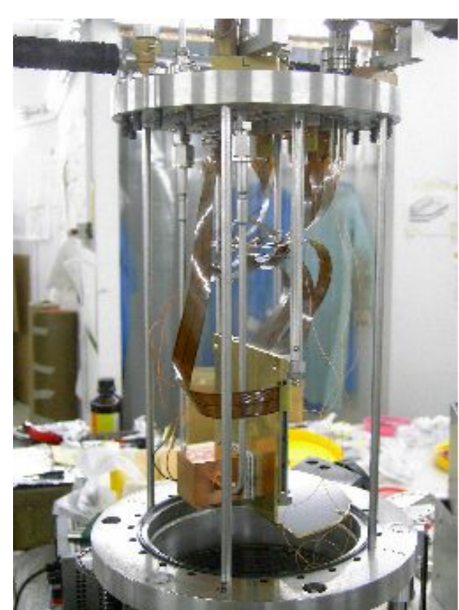
Foto des energiesensitiven Multistreifen Detektors vor dem Einbau in die Hochvakuumdetektorkammer am TSR
